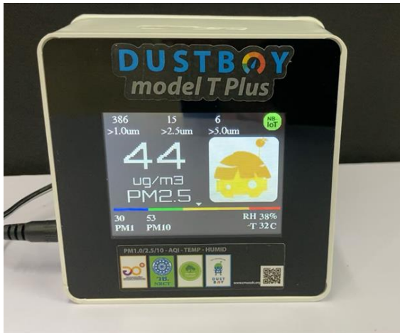
รูปที่ 6 เครื่องตรวจวัดและพารามิเตอร์ตรวจวัดเก็บข้อมูลปริมาณฝุ่น PM2.5 และPM10
